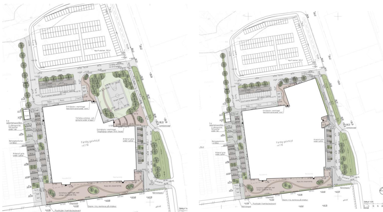
Bild 23. Situationsplaner med förslag på utformning av kvartersmark. Vänstra bilden etapp 1 med tre hallar, med förslag på nyttjande av den nordöstra delen som utemiljö. Högra bilden visar etapp 2 med fullt antal hallar. (Tengbom)
