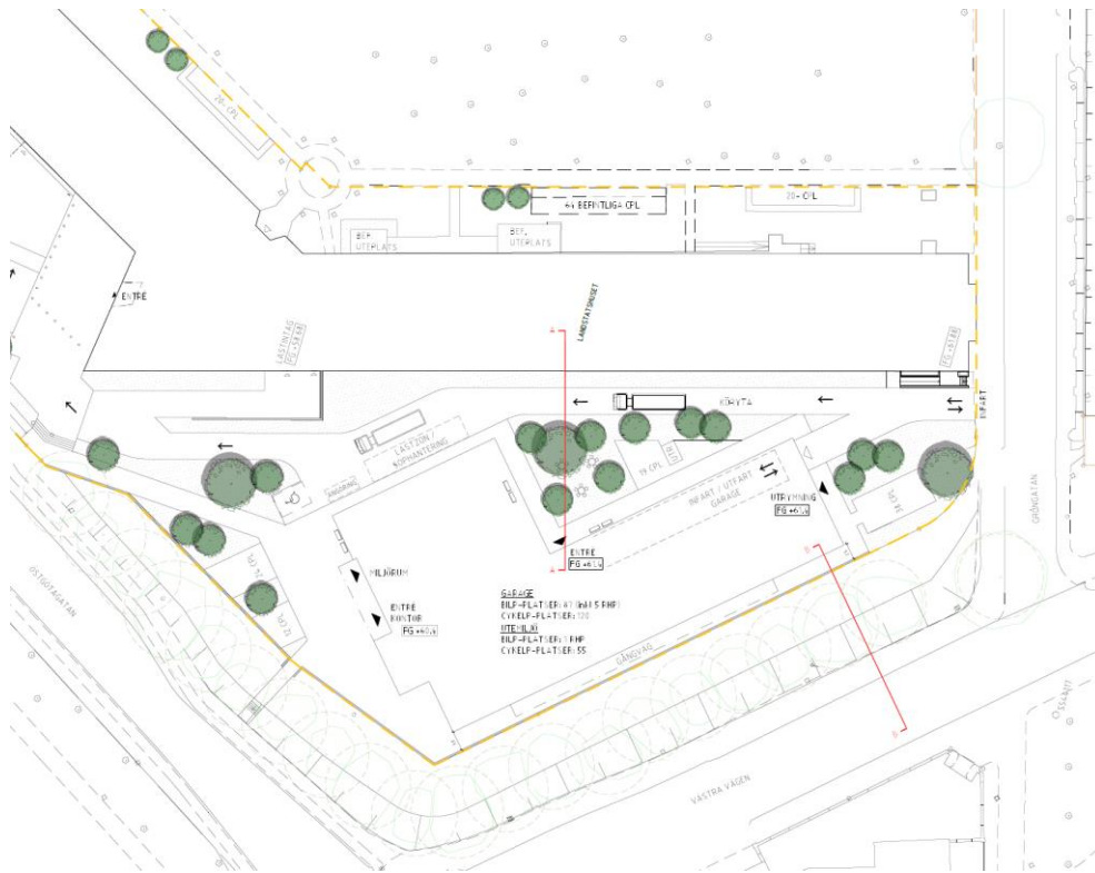
Bild. Utklipp från situationsplanen som visar den nya byggnadens utformning med entréer. Parkering för rörelsehindrade löses utanför entréerna (White, 2024-12-06).
