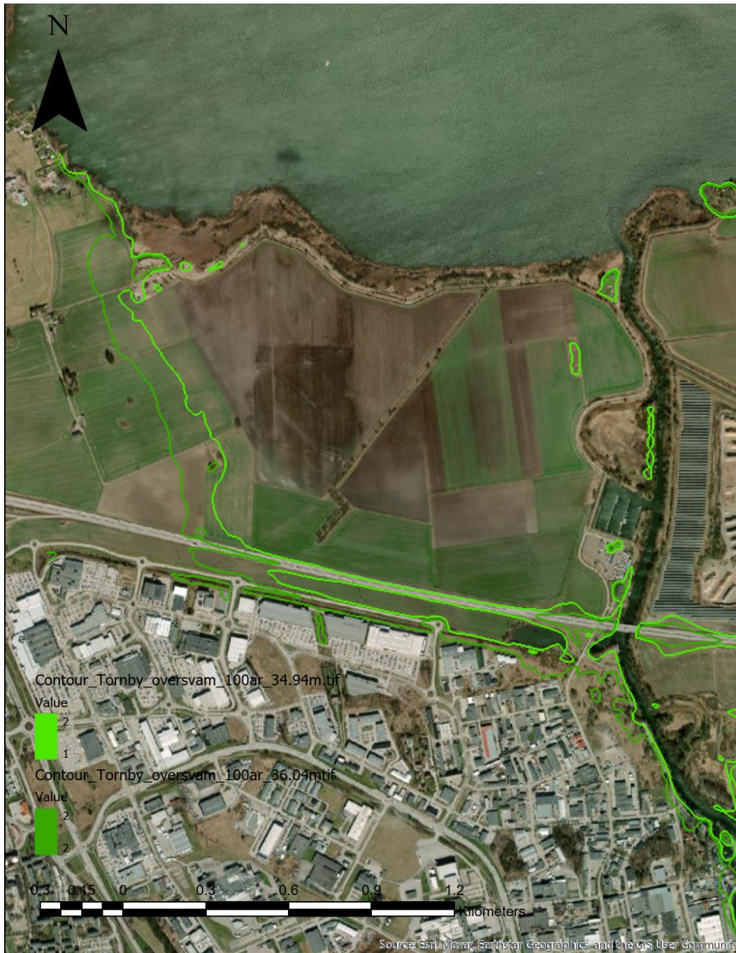
Figur 7. Modellerad vattenutbredning vid 100 års nivåer på Roxen baserad på SMHI's nivåberäkningar, med och utan våg och vind påverkan. Ljusgrön visar 100-årsnivå utan påverkan av vind och vågor. Mörkgrön visar 100-årsnivå med maximal påverkan från vind och vågor.
