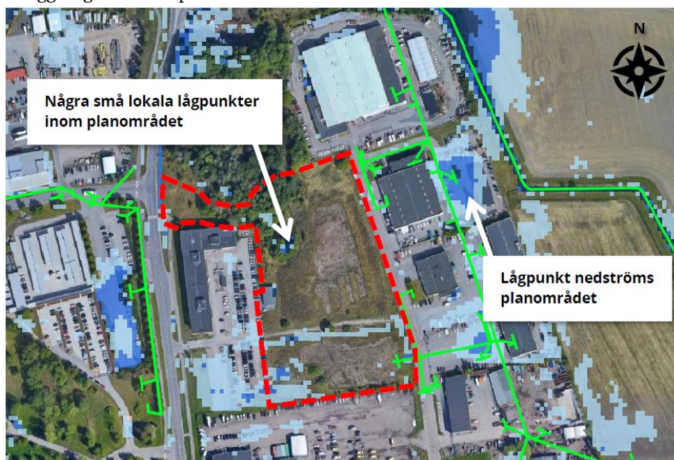
Bild 44. Översiktlig bild av DHI:s skyfallskartering (2019) av planområdets omnejd. Ljusblå färg i bilden visar vattendjup 0.1-0.3 m. Djup större än 0.3 m visas i mörkare färger. Röd linje visar ungefärlig gräns av planområdet.
