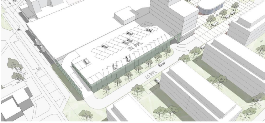
Lastintaget är integrerat i centrumbyggnaden, och parkering kan anläggas på taket. Tengbom 2024.
