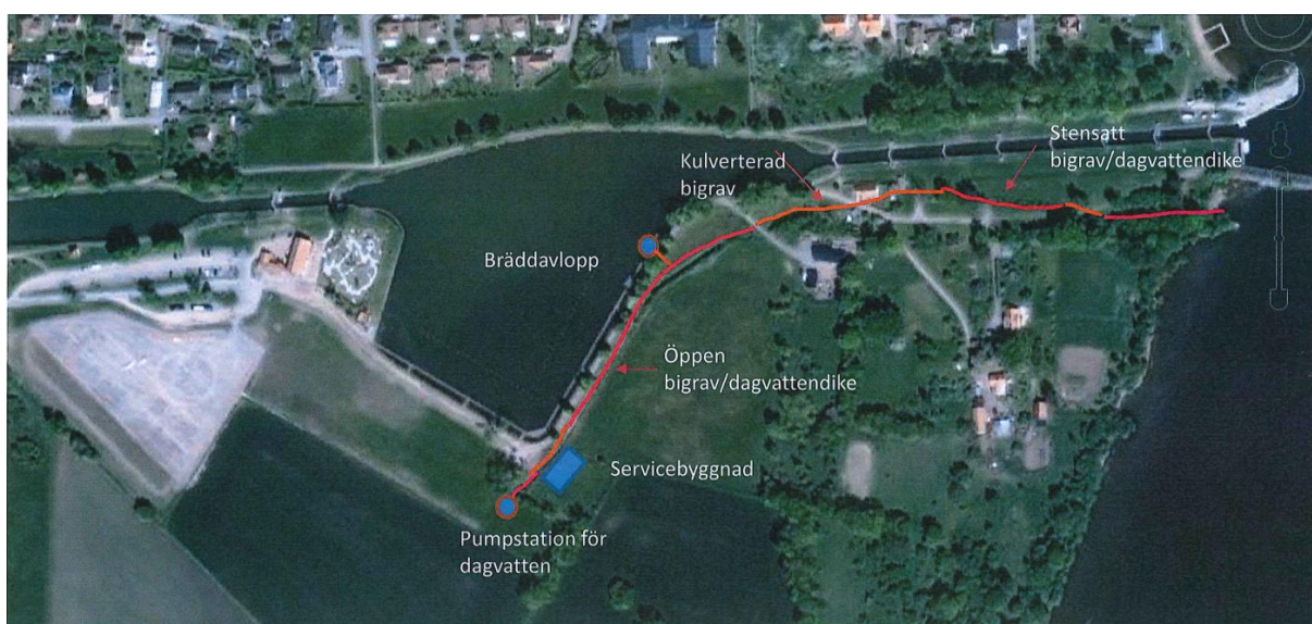
Bild. Dagvattenhanteringen idag i anslutning till planområdet. Dagvattendiket ingår inte i planområdet. (Illustration Kanalbolaget)
