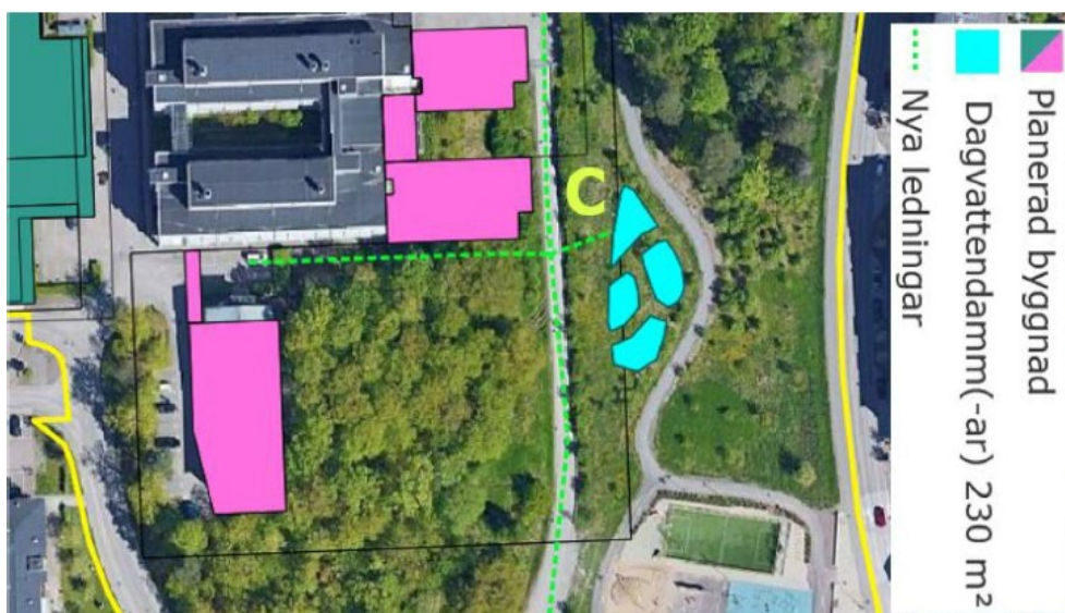
Förslag på placering av dagvattendamm(-ar) inom allmän plats, strax norr om aktivitetsparken (Ramboll).
