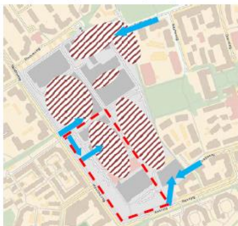
Figur 1: Principskiss för parkeringsanläggningarna inom Wahlbecksområdet, placering och infarter till dessa, aktuellt planområde markerat med rött.
