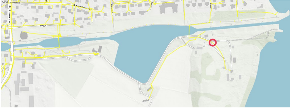
Bild. Befintliga elledningar (gul kulör). Röd cirkel visar ungefärlig plats för en ny nätstation.
