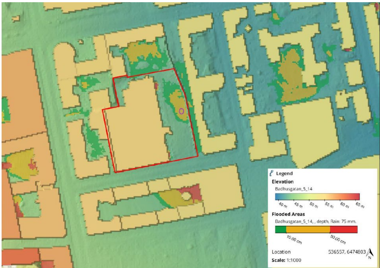
Karta från dagvattenutredning för Badhuset 14 framtagen av AFRY som visar simulering av 100-års skyfallsregn för befintligt förhållande. Den lila cirkeln visar det maximala vattendjupet i det översvämmande området på innergården.
