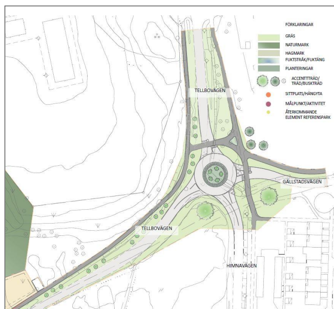
Bild 28. Bilden visar principritning över föreslagen cirkulationsplats med gång- och cykelpassager i norr och öster.
