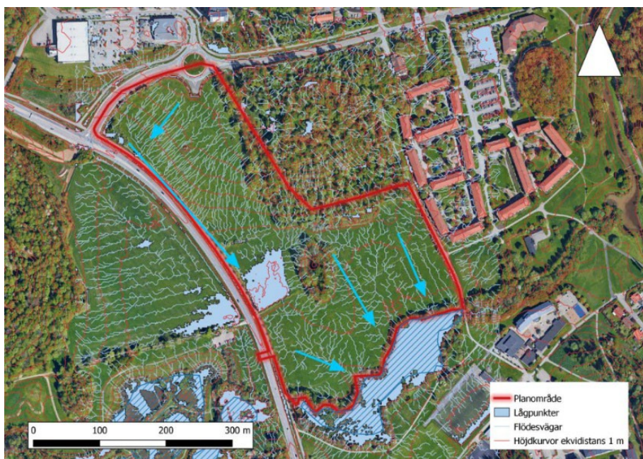
Figur 22: Ytavrinningen inom planområdet med befintlig markanvändning. Modellen räknar med att allt vatten rinner längs ytan. Pilarna förtydligar flödesriktningen. (Geosigma AB, 2022)
