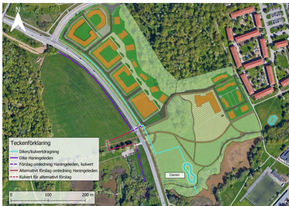
Figur 21: Alternativ för kulvertering av diket som följer Haningeleden. Valt alternativ är den vinröda sträckningen för att undvika påverkan på främst källfräne i befintligt dike. (Geosigma AB, 2022)
