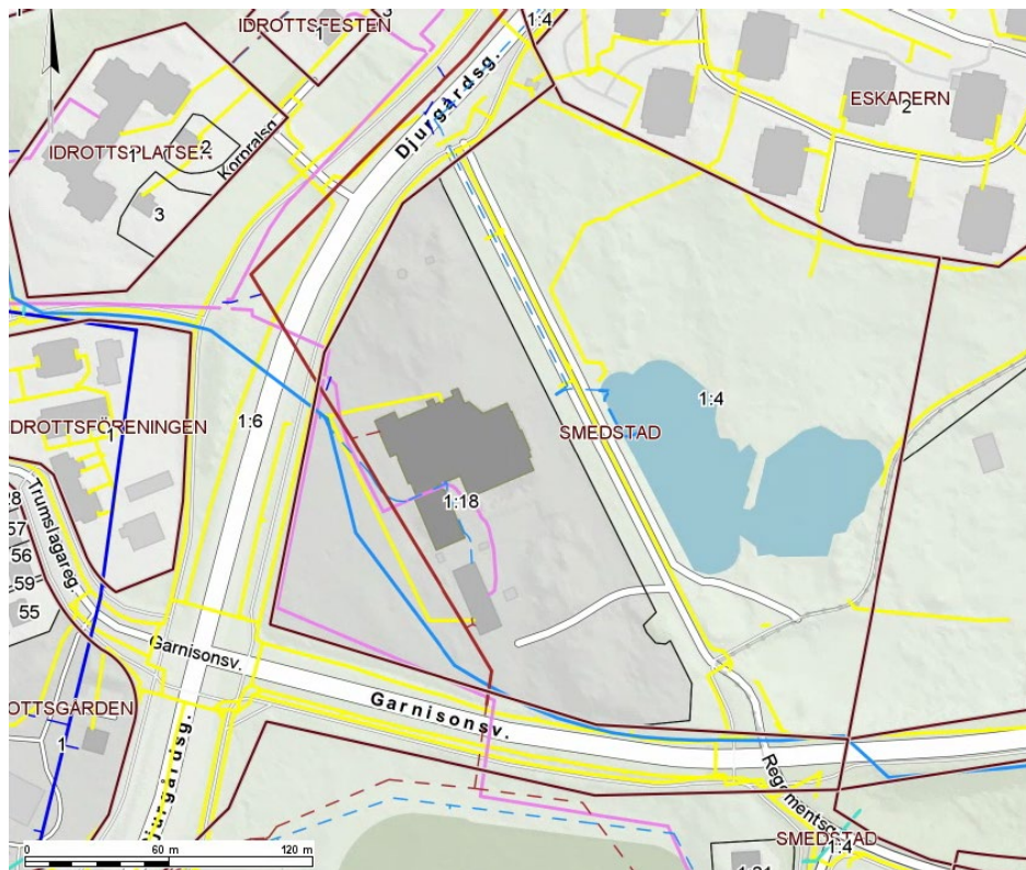
Karta som visar befintliga ledningar. Blå linje är huvudledning för vatten, röd linje är huvudledning för spillvatten, rosa linje är fjärrvärme och gul linje är el.
