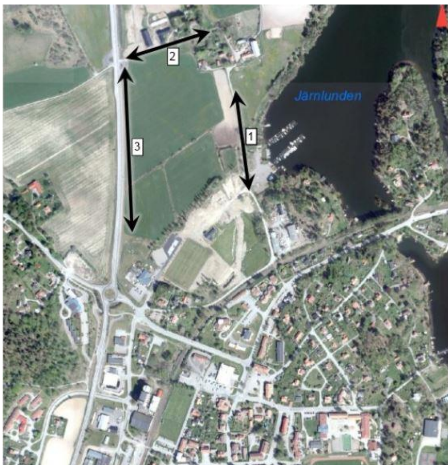
Figur 21. Möjlig placering av åtgärder för översvämningsskydd från Järnlunden.
