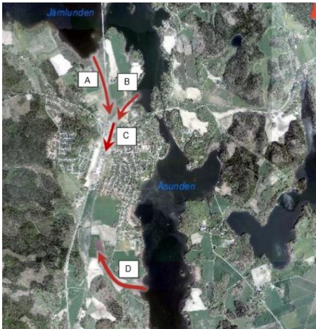
Figur 20. Principiella flödesvägar för vatten vid höga vattennivåer i Järnlunden och Åsunden.
