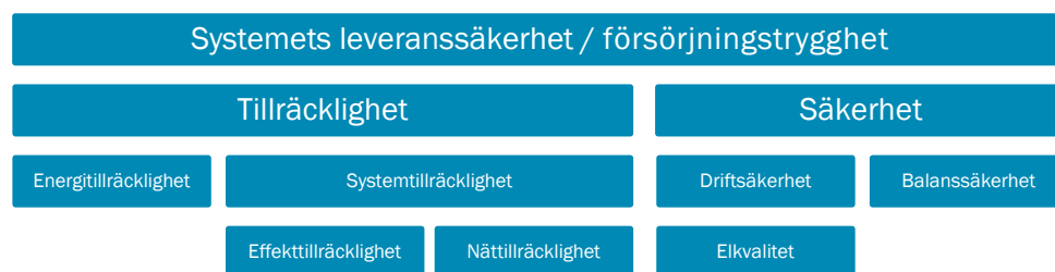
Figur 10. Schematisk bild över de insatsfaktorer som bestämmer elsystemets leveranssäkerhet.
