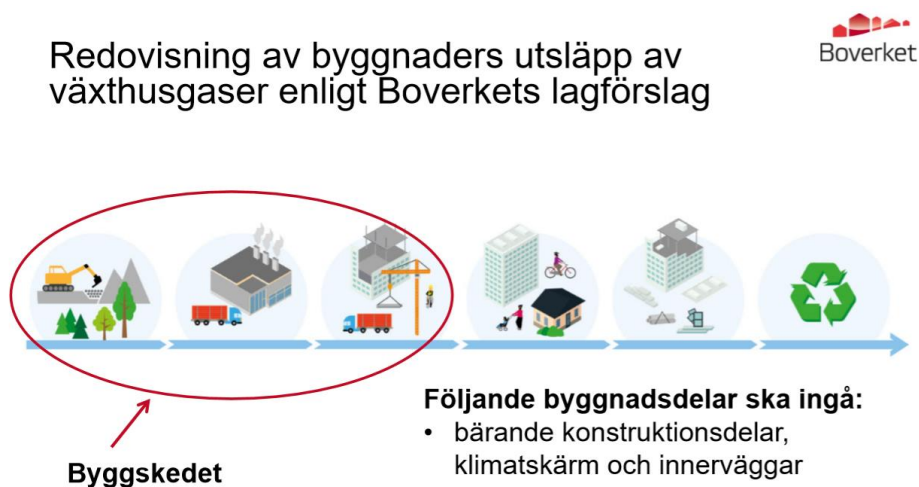
Figur 14. Avgränsning av byggnaders utsläpp av växthusgaser enligt Boverkets lagförslag. Källa: Boverket (2020d).
