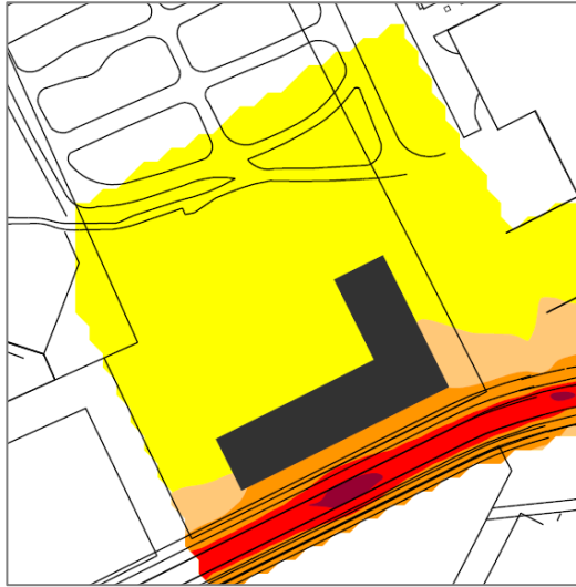
I bilden visas dygnsekvivalent ljudnivå 1,5 m över mark för skoltomten. Gul färg är 50 dBA eller lägre, beige 50-55 dBA, orange 55-60 dBA, röd 60-65 dBA.
