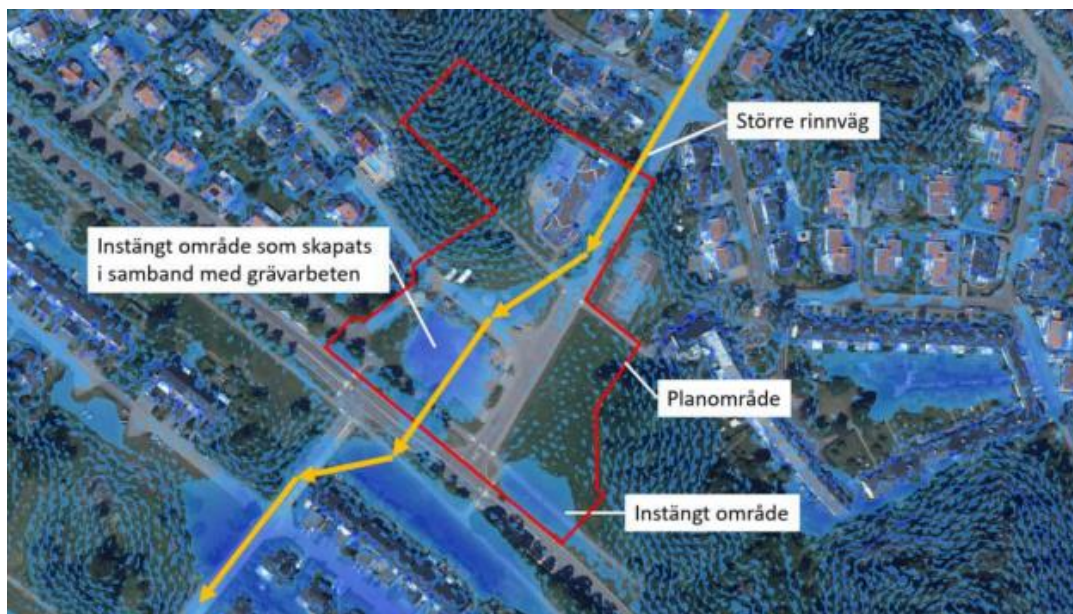
Bilden visar maximala vattendjup vid 100-års regn, befintlig situation med dynamisk modell. Klimatfaktor 1,3. Planområdet har till följd av dagvattenutredningen utökats, vilket inte framgår av denna bild.
