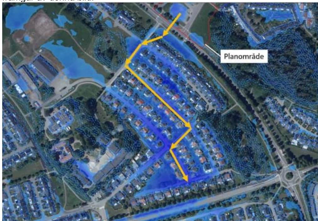
Bilden visar yttlig rinnväg nedströms planområdet innan planförslaget (gula pilar). Skyfallskarteringen visar maximala vattendjup vid 100-års regn med klimatfaktor 1,3.
